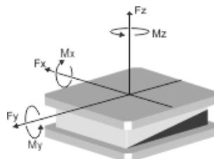
Aufgrund der umfangreichen Konfigurationsmöglichkeiten ist eine pauschale Angabe von maximalen Kräften und Momenten bei exzentrischer Krafteinwirkung nur bedingt möglich.
